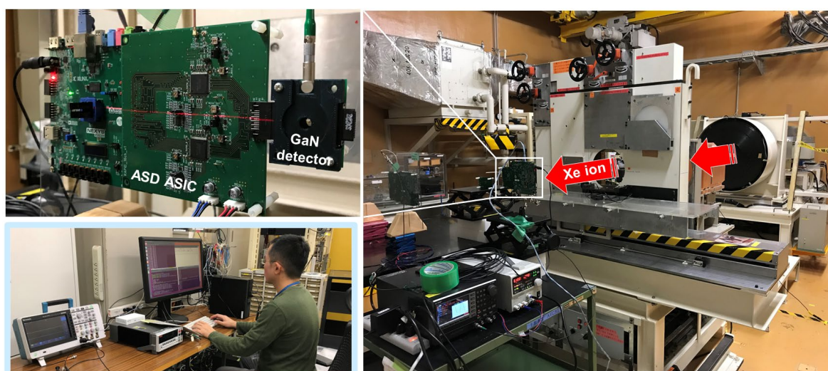
図1:HIMACでのGaN LGADへのXe重粒子照射実験の様子
