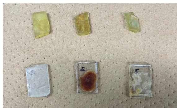
図 2. \text{NiFeO}_x/\text{Mo-BiVO}_4 (上段左から dip 法、drop-cast 法、spin-coat 法)及び \text{NiFeO}_x/\text{FTO} (下段左から dip 法、drop-cast 法、spin-coat 法にて作製)の画像
