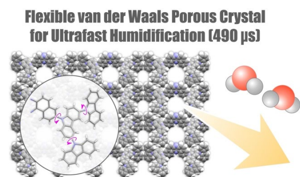
図3 弱い多孔質結晶の内部で分子が一斉に変形し、それに伴い水分が排出される現象の模式図。
