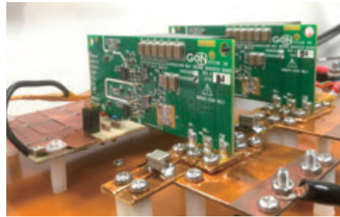
図 1・2 GaN を用いた試作高周波インバータ
